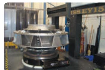
КИМ Finist серии С предназначена для измерений крупногабаритных заготовок. Усовершенствованное ПО, анализ по методу конечных элементов, исследование динамических свойств - обеспечивают высокую точность и стабильность.
